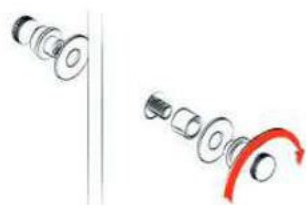
Glastürbohrung \varnothing 11 mm Glastürbefestigung HANDFEST verschrauben.
