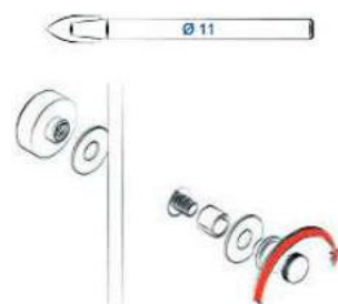
Glastürbohrung \varnothing 11 mm Glastürbefestigung HANDFEST verschrauben.
